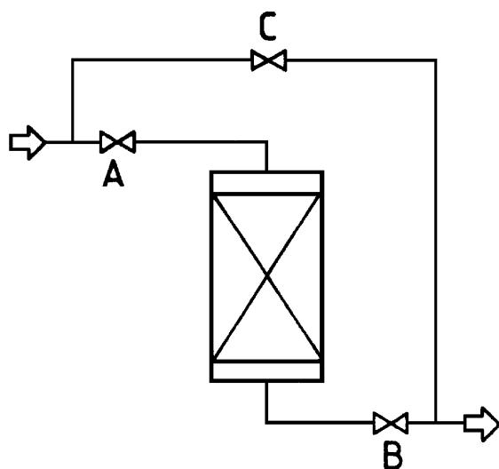
**Fig. 1: Tubería de desviación**
